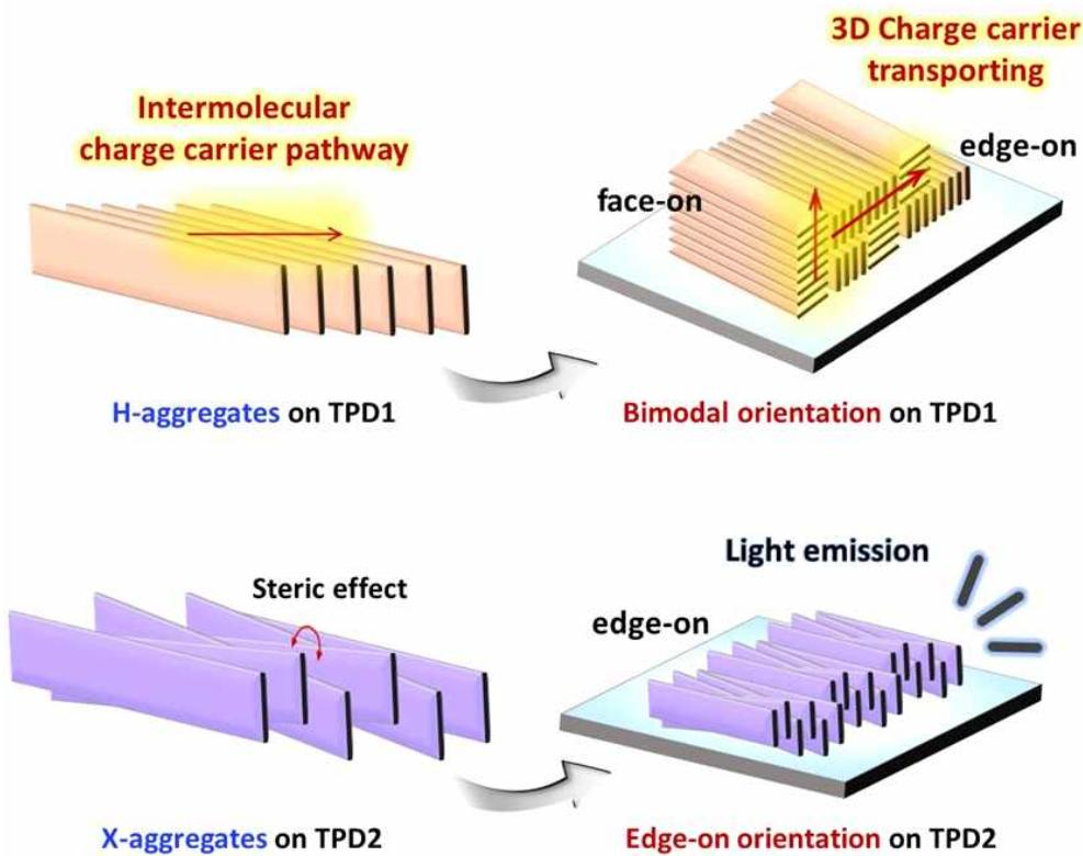
[그림] 고분자 사슬의 응집 형태와 배향 방향에 대한 모식도
